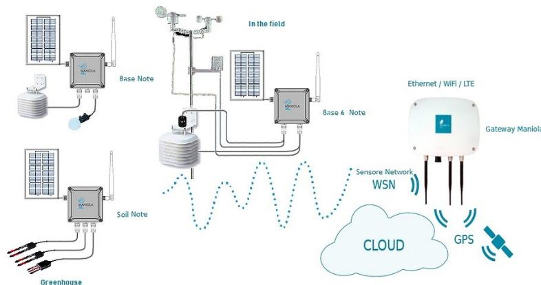
HYDRA MOTE, è il sistema integrato per la gestione degli impianti di irrigazione e fertirrigazione, costituito da schede rice-trasmettenti configurabili per poter definire, leggere, controllare e modulare i parametri provenienti dall'ambiente.
